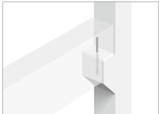
Abb. 16: Schöck Stacon®: Lagesicherung eines Balkens auf einer Konsole
