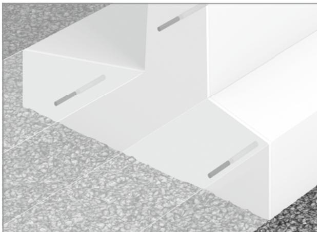
Abb. 15: Schöck Stacon®: Dehnfuge in Winkelstützmauer
