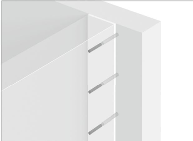
Abb. 11: Schöck Stacon®: Anschluss Wand–Wand (Stirn–Flanke)
