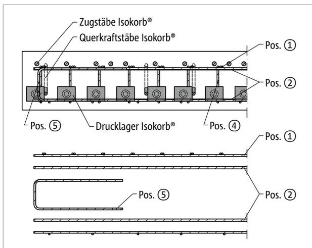
Abb. 56: Schöck Isokorb® T Typ K-M12: Bauseitige Bewehrung balkonseitig im Schnitt A-A; Pos.5 = konstruktive Randeinfassung am freien Rand
