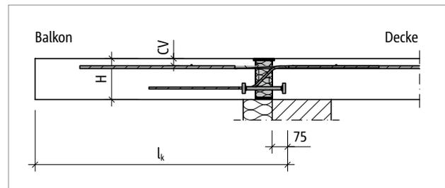
Abb. 31: Schöck Isokorb® T Typ K-M12: Statisches System
