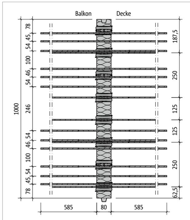
Abb. 37: Schöck Isokorb® T Typ K-M4-V1: Produktgrundriss
