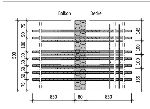
Abb. 46: Schöck Isokorb® T Typ K-M13-V1: Produktgrundriss
