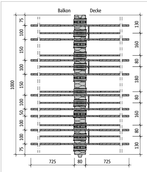
Abb. 41: Schöck Isokorb® T Typ K-M8-V1: Produktgrundriss
