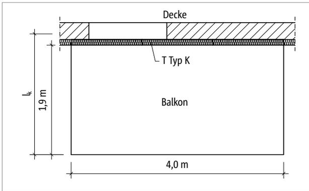
Abb. 62: Schöck Isokorb® T Typ K: Grundriss
