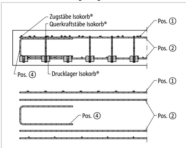
Abb. 50: Schöck Isokorb® T Typ K-M1 bis M11: Bauseitige Bewehrung balkonseitig im Schnitt A-A; Pos.4 = konstruktive Randeinfassung am freien Rand senkrecht zum Schöck Isokorb®
