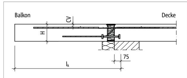
Abb. 33: Schöck Isokorb® T Typ K-M12: Statisches System
