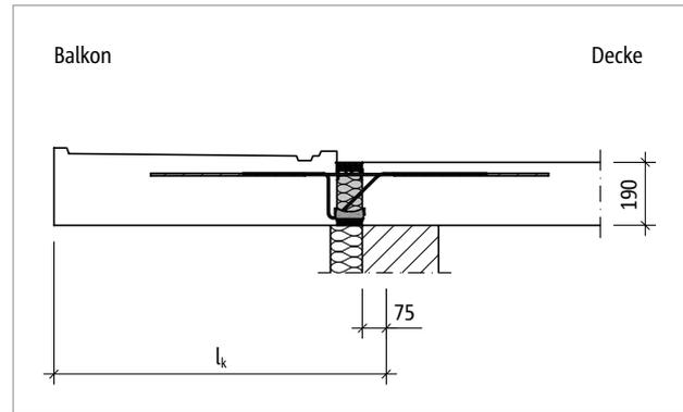
Abb. 63: Schöck Isokorb® T Typ K: Statisches System
