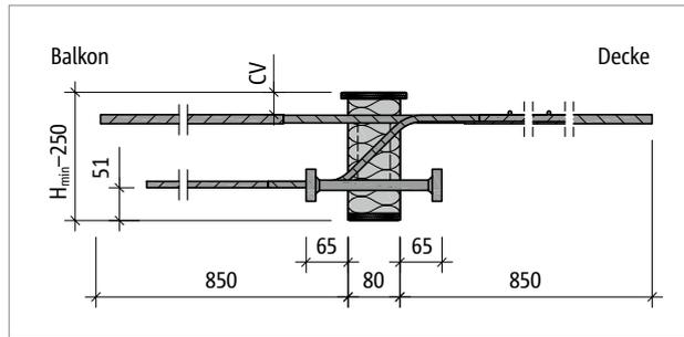
Abb. 43: Schöck Isokorb® T Typ K-M12: Produktschnitt
