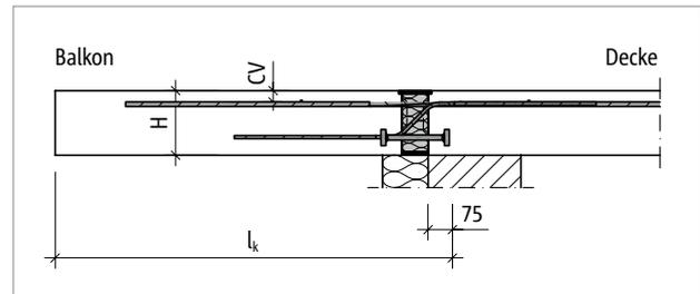
Abb. 28: Schöck Isokorb® T Typ K-M12: Statisches System
