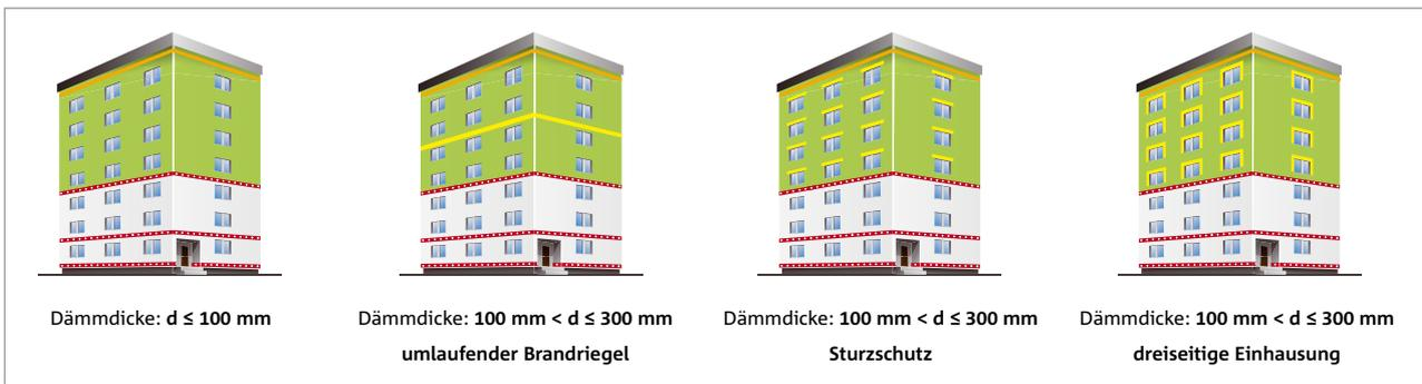
Abb. 2: Konstruktive Brandschutzmaßnahmen an höheren Gebäuden (beispielhaft) (© Fachverband WDVS/VDPM)
