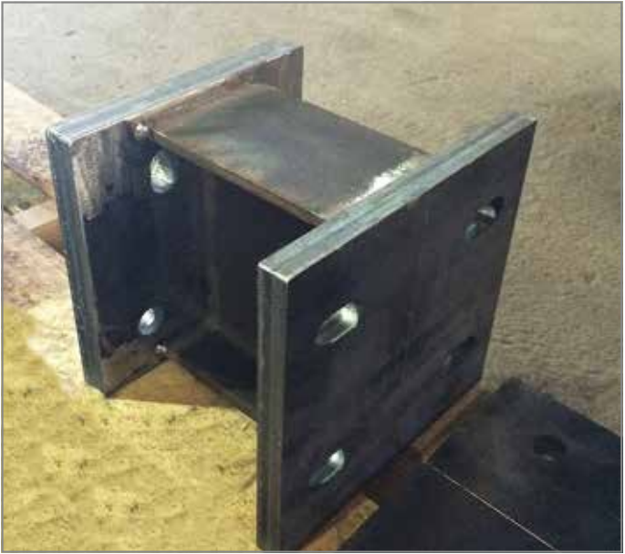
Abb. 34: Adapter mit horizontalen Langlöchern
