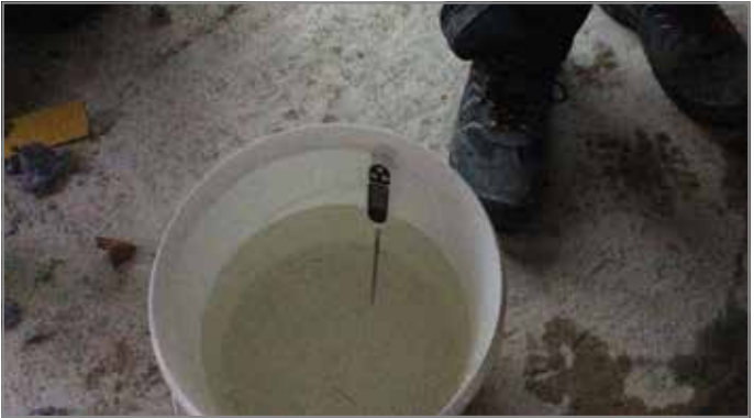
Abb. 56: Temperatur messen, Wasser
