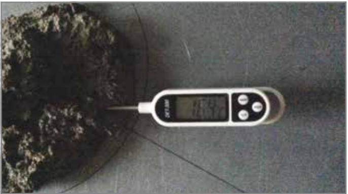
Abb. 57: Temperatur messen, fertige Mischung
