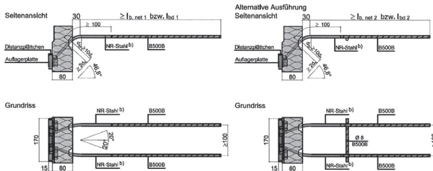
Abb. 25a bis 25d: Querkraftstäbe 2 Ø d<sub>s</sub> inkl. Auflagerplatte
