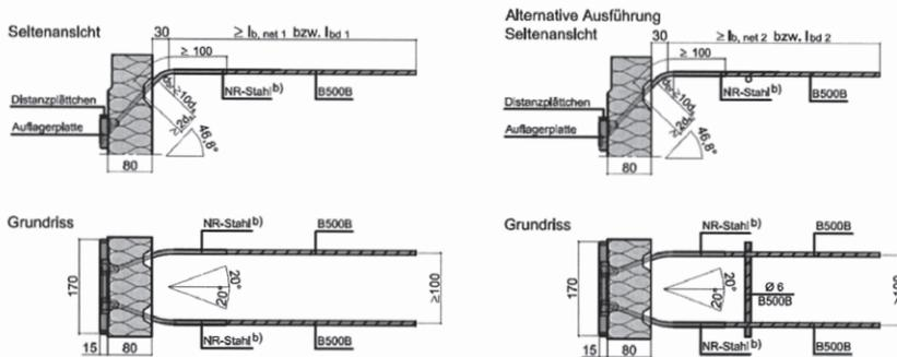
Abb. 14a bis 14d: Querkraftstäbe 2 Ø 8 inkl. Auflagerplatte
