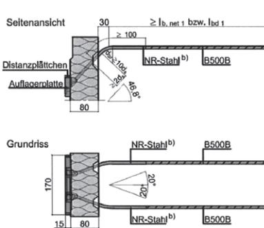
Abb. 9a bis 9d: Querkraftstäbe 2 Ø d<sub>s</sub> inkl. Auflagerplatte
