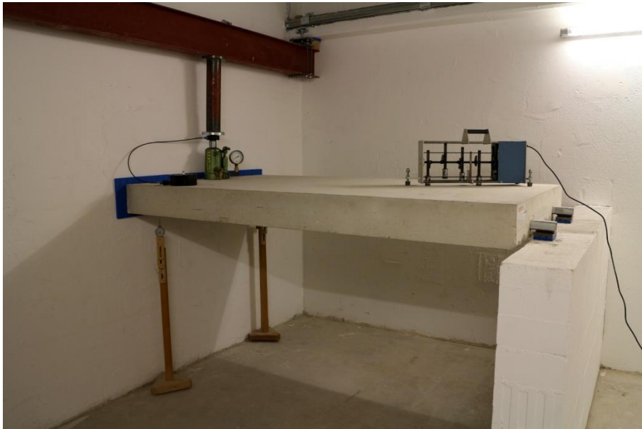
Abbildung 7: Entkoppeltes Referenztreppenpodest mit 4 Konsolen und Hydraulikpresse zur Erzeugung bauüblicher Zusatzlasten
