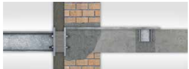
Frei auskragender Stahlbalkon, nachträglich angeschlossen mit Schöck Isokorb® T Typ S an bestehende Stahlbetondecke.
