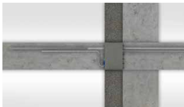
Frei auskragender Stahlbetonbalkon, nachträglich angeschlossen mit Schöck Isokorb® Typ RK an bestehende Stahlbetondecke.
