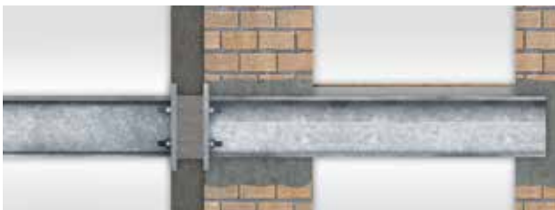
Frei auskragender Stahlbalkon, nachträglich angeschlossen mit Schöck Isokorb® T Typ S an eingebauten Stahlträger.
