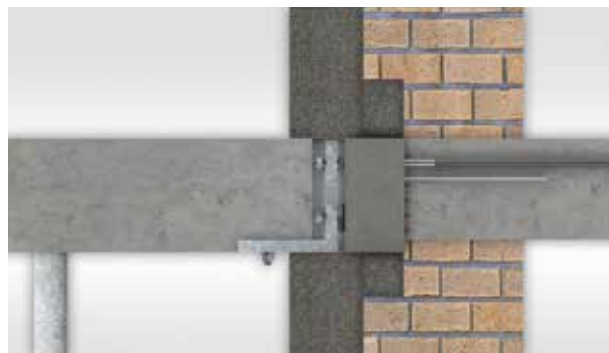
Gestützter Stahlbetonbalkon, nachträglich angeschlossen mit Schöck Isokorb® Typ RKS an bestehende Stahlbetondecke im Mauerwerk.
