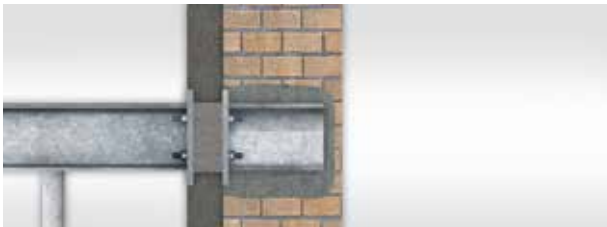
Gestützter Stahlbalkon, nachträglich angeschlossen mit Schöck Isokorb® Typ KST an eingebautes Wandauflager.
