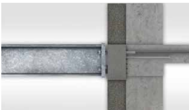
Frei auskragender Stahlbalkon, nachträglich angeschlossen mit Schöck Isokorb® RT Typ SK an bestehende Stahlbetondecke.
