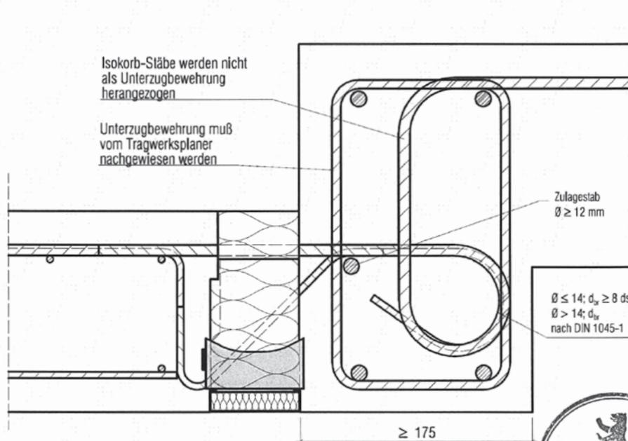
Abb. 28 Schöck Isokorb Typ K mit Druck- Querkraft Kombination (Variante Höhenversatz) und integrierter Aufhängebewehrung (balkenseitig).
