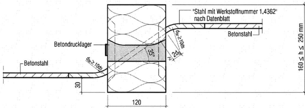
Abb. 16 Schöck Isokorb Typ Q mit Betondrucklager
