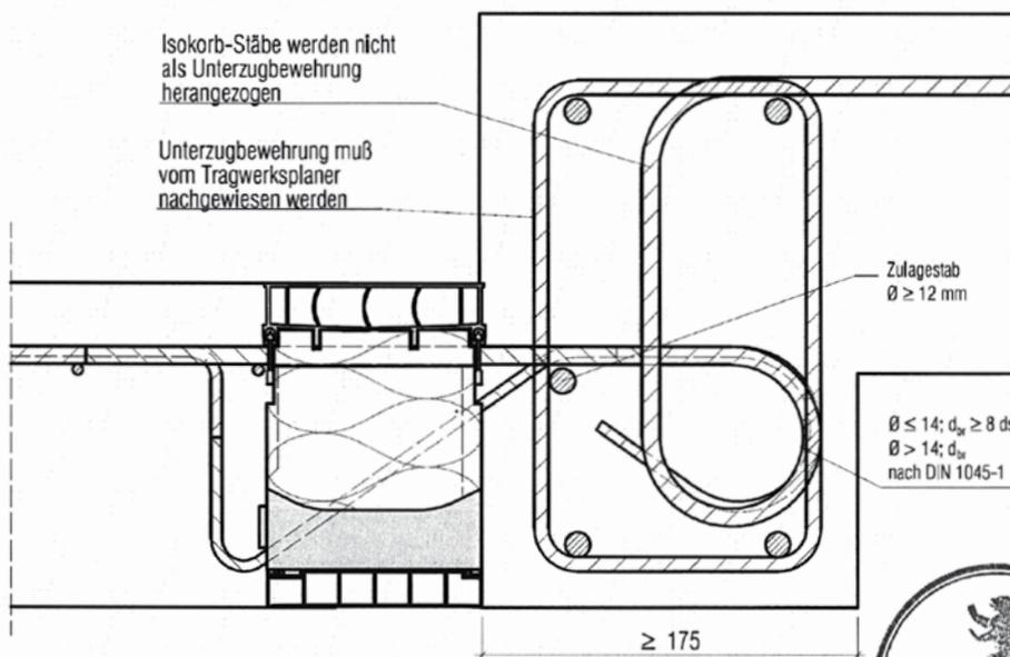
Abb. 30 Schöck Isokorb Typ K mit Druck- Querkraft Kombination (Variante Höhenversatz) und integrierter Aufhängebewehrung (balkenseitig).
