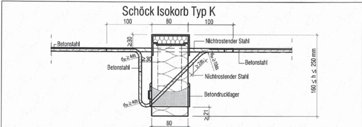
Abb. 9 Schöck Isokorb Typ K<sup>1)</sup> mit Druck- Querkraft Kombination und integrierter Aufhängebewehrung
