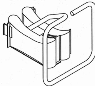
Abb. 23 Betondrucklager mit Bügel
