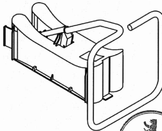
Abb. 26 Betondrucklager mit Bügel
