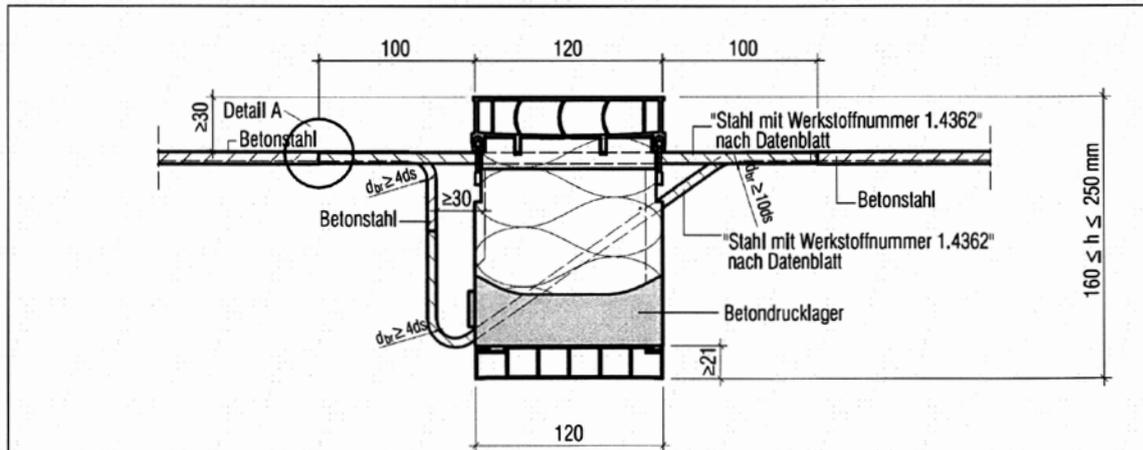
Abb. 19 Schöck Isokorb Typ K mit Druck- Querkraft Kombination, integrierter Aufhängebewehrung und Drucklageraufhängung
