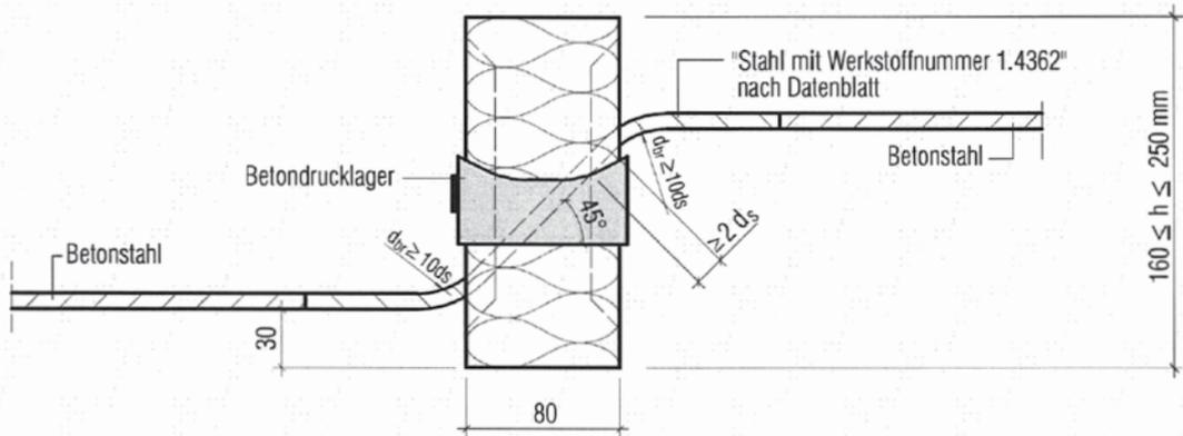
Abb. 15 Schöck Isokorb Typ Q mit Betondrucklager
