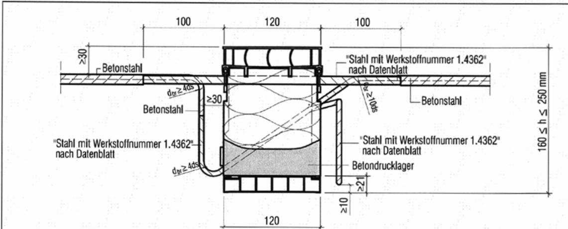
Abb. 24 Schöck Isokorb Typ K mit Druck- Querkraft Kombination, integrierter Aufhängebewehrung und Drucklageraufhängung
