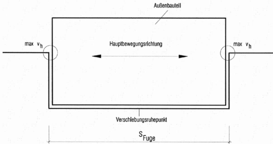
Abb. 47 Einbausituation mit Lagerung an gegenüberliegenden Rändern
