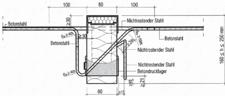
Abb. 21 Schöck Isokorb Typ K<sup>1)</sup> mit Druck- Querkraft Kombination, integrierter Aufhängebewehrung und Drucklageraufhängung
