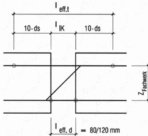
Abb. 49  $l_{\text{eff}}$ . "Stahl mit Werkstoffnummer 1.4362" nach Datenblatt
