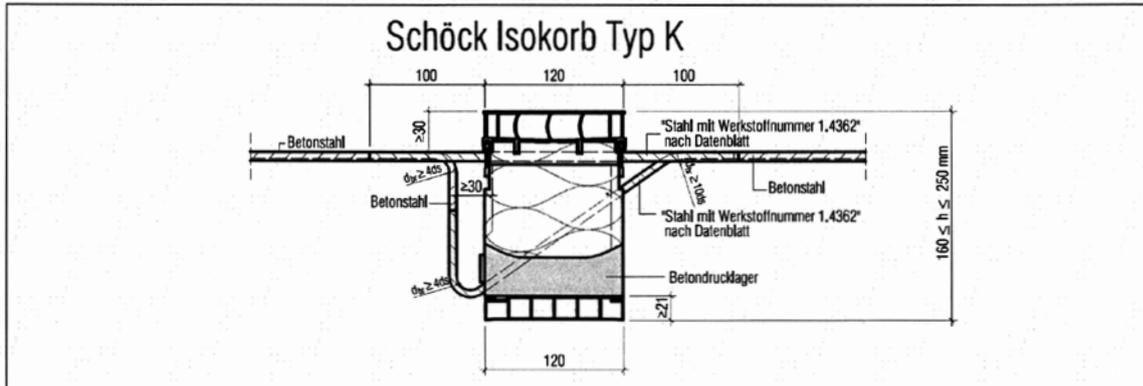
Abb. 12 Schöck Isokorb Typ K mit Druck- Querkraft Kombination und integrierter Aufhängebewehrung
