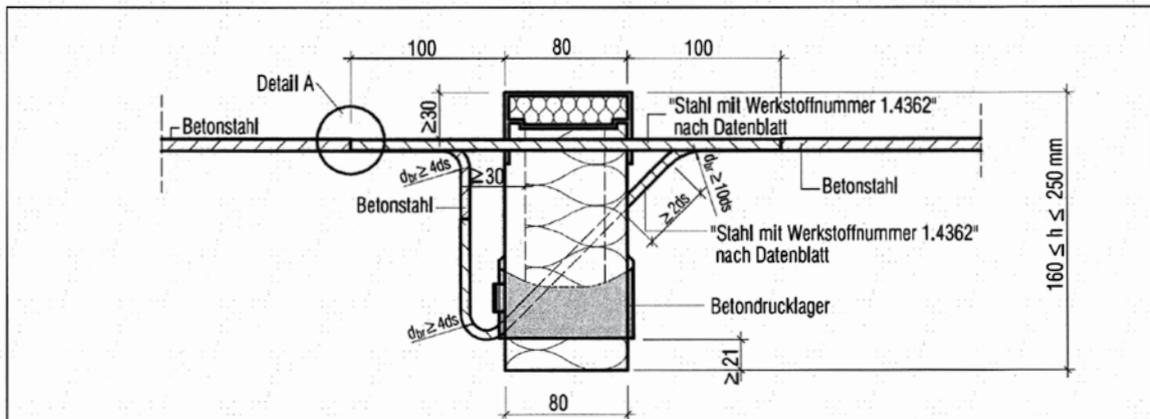
Abb. 17 Schöck Isokorb Typ K mit Druck- Querkraft Kombination, integrierter Aufhängebewehrung und Drucklageraufhängung
