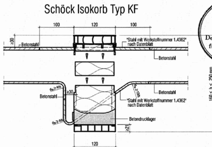
Abb. 14 Schöck Isokorb Typ KF mit Druck- Querkraft Kombination und integrierter Aufhängebewehrung
