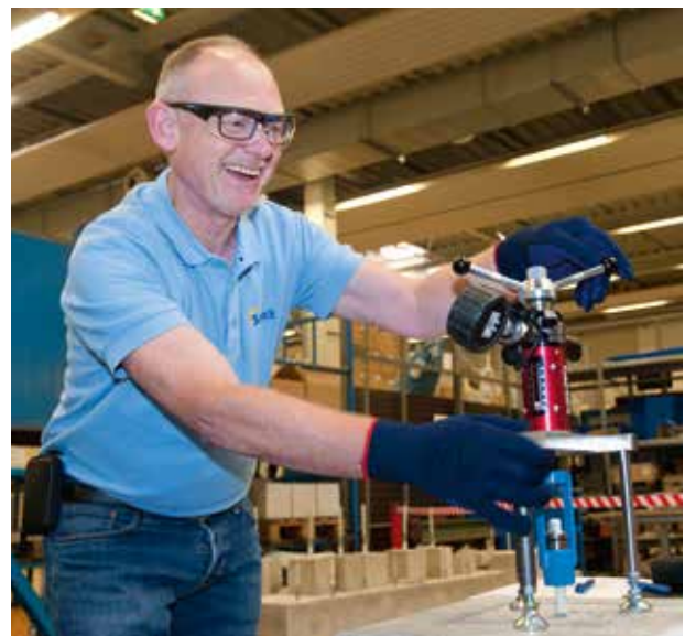
Geprüfte Sicherheit: seit 2016 führen die Einbaumeister Auszugsprüfungen im Fertigteilwerk durch.
