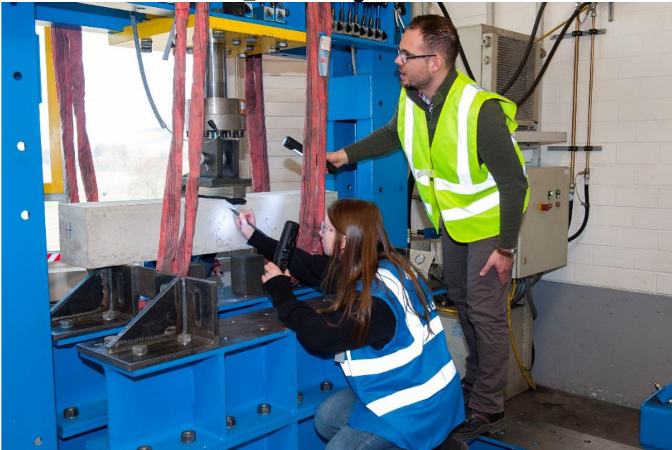
Nachdem die Versuchskörper ausgehärtet waren, wurde mittels eines Dreipunkt-Biegeversuchs im Prüflabor von Schöck untersucht, wie tragfähig die erarbeiteten Berechnungen sind. (Foto: Schöck Bauteile GmbH, Abdruck honorarfrei.)
