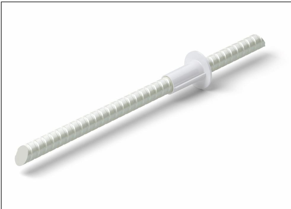
*Der Schöck Isolink Typ TA-HC ist eine Fassadenbefestigung aus Glasfaserverbundwerkstoff für kerngedämmte Betonwände. Er ist mit einem Tiefenbegrenzer ausgestattet, der die Einstecktiefe in die Vorsatzschale begrenzt. Foto: Schöck Bauteile GmbH, Abdruck honorarfrei.*
