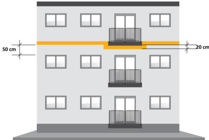
Begehbare, an der Fassade auskragende Außenbereiche, wie z.B. Balkone und Laubengänge, die ein WDVS vollständig horizontal unterbrechen, übernehmen in diesem Bereich die Funktion einer Brandsperre, so dass auf die zusätzliche Ausführung von Brandriegeln in diesem Bereich verzichtet werden kann.
