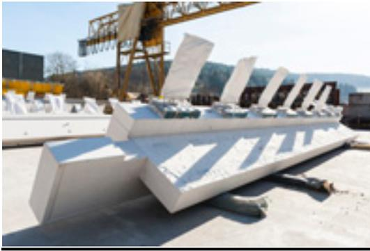
Die im FTW produzierten Gesimselemente mit dem tragenden Wärmedämmelement
