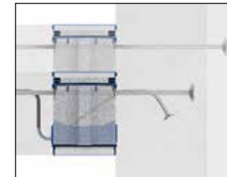
Isokorb® XT/T Typ K-U für den Höhenversatz nach unten, mit 120 oder 80 mm Dämmdicke und in verschiedenen Höhen, auch in der Wand einsetzbar
