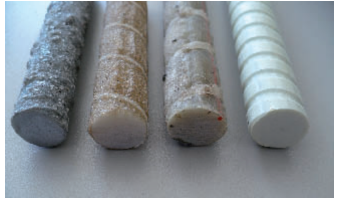
Bild 3. Verschiedene Oberflächengestaltungen bei GFK-Bewehrungsstäben Fig. 3. Different surfaces geometries of GFRP-rebars
