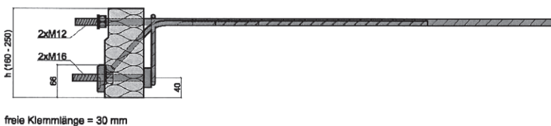
Abb. 22 Seitenansicht: Schöck Isokorb Typ RKS10
