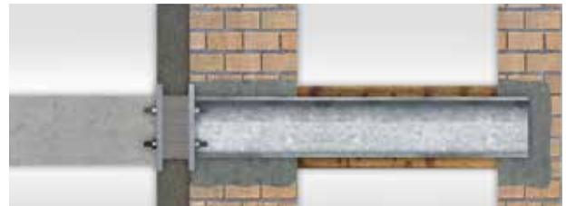
Frei auskragender Beton-Fertigteilebalkon, nachträglich angeschlossen mit Schöck Isokorb® T Typ S an bestehende Holzbalkendecke.
