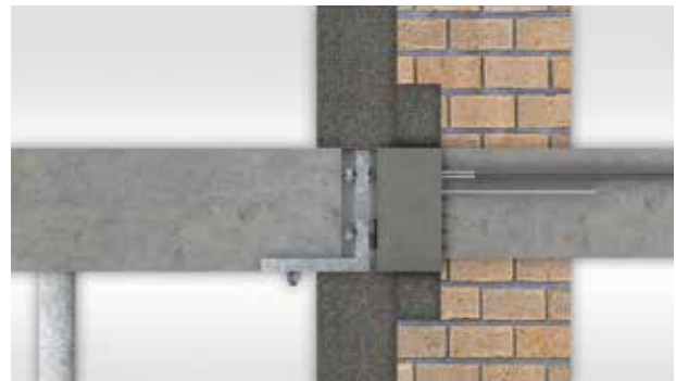
Gestützter Stahlbetonbalkon, nachträglich angeschlossen mit Schöck Isokorb® RT Typ SK an bestehende Stahlbetondecke im Mauerwerk.
